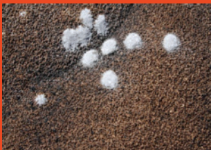
Kuvassa vasemmalla fosfiinkaasutuksen lähtöainejäämiä
